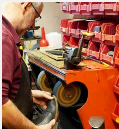
Viele Schuhe müssen von Johann Grindhammer neu besohlt und dafür zunächst abgeschliffen werden.
