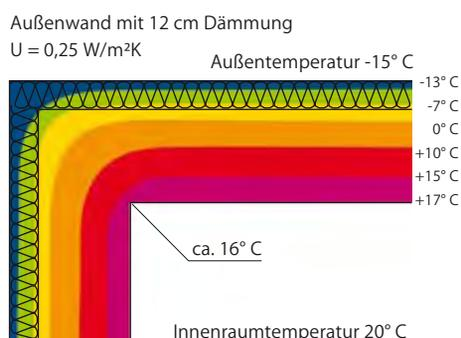
Abb 36 | Oberflächentemperaturen ohne und mit Dämmung
