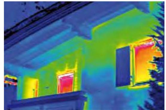
Abb 22 | Mit Thermografieaufnahmen werden Schwachstellen sichtbar gemacht.
