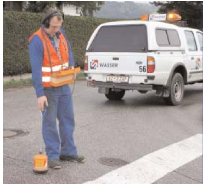
Martin Pachler bei der Lecksuche (Grobsuche) mit einem elektro-akustischen Messgerät.
