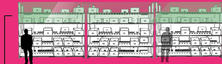
Das Regalsystem wird an der Lifschleife mit den genommenen Kästen eingepostet - die Rollen setzen sich in Bewegung und die Ware erreicht den Bestimmungsort. Es werden automatisch keine Positionen erkannt und die Ware - nach Rücksprache mit der Kassierin - wird an die optimale Stelle gesetzt.
